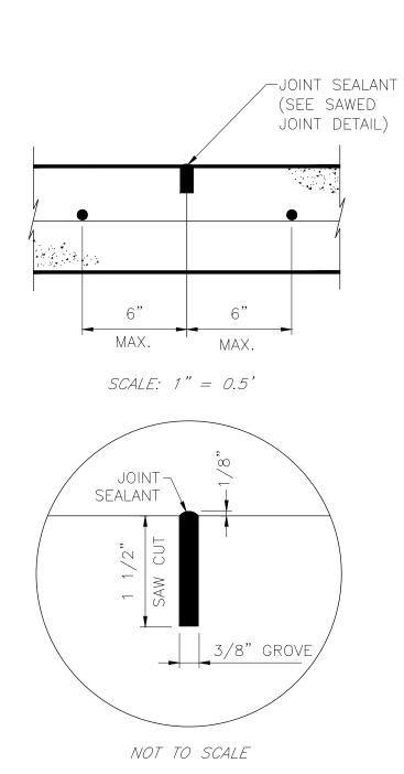
SAW CUT CONTROL JOINT
